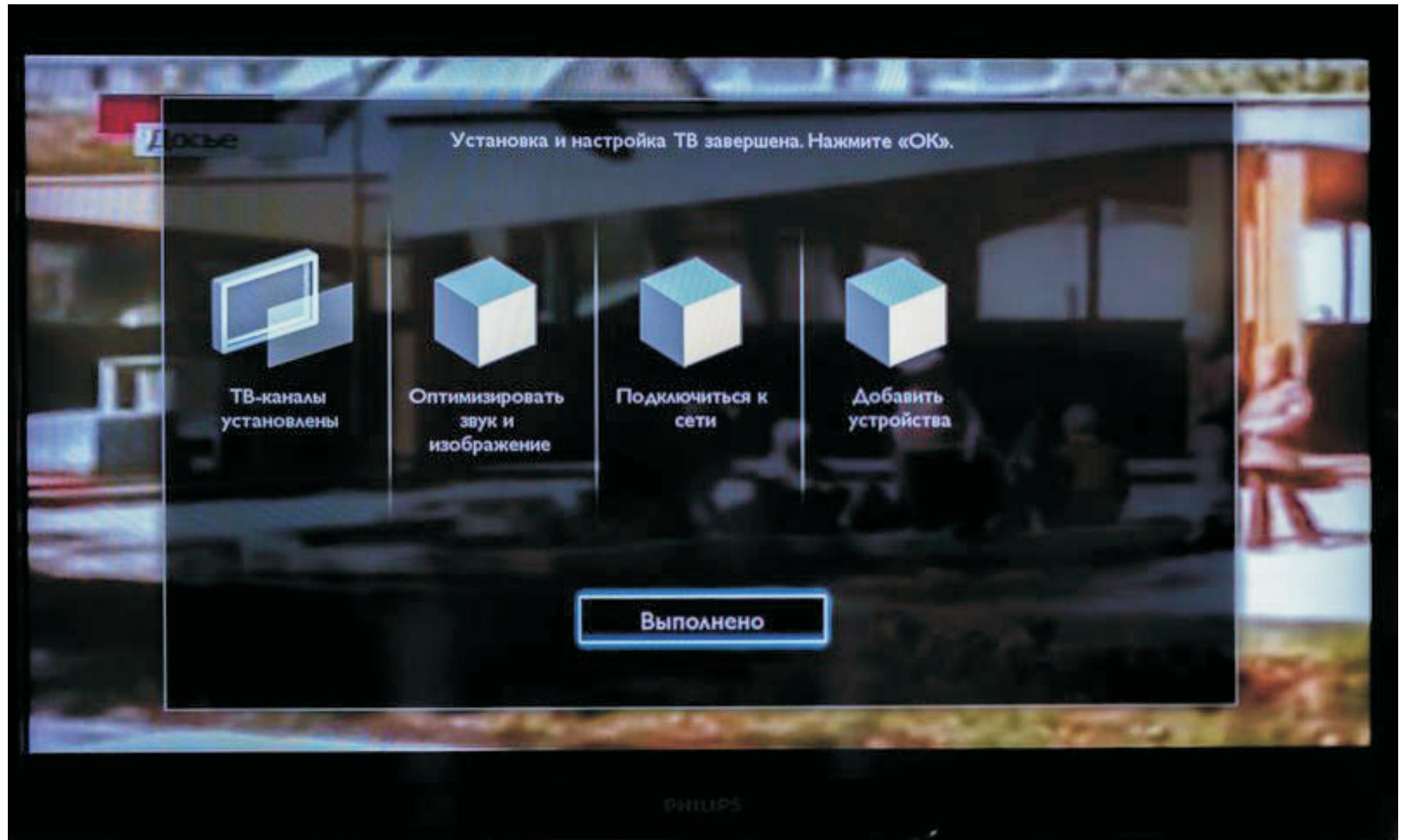
После окончания поиска каналов, ТВ приемник выдаст текстовое сообщение о завершении установки и настройки. Пометьте кнопку **Завершение**, нажмите **OK**. Бесплатное обновление программного обеспечения вашего ТВ приемника и другая полезная информация по нему, будет возможна после регистрации телевизора по адресу в Интернет, указанному в диалоговом окне.
