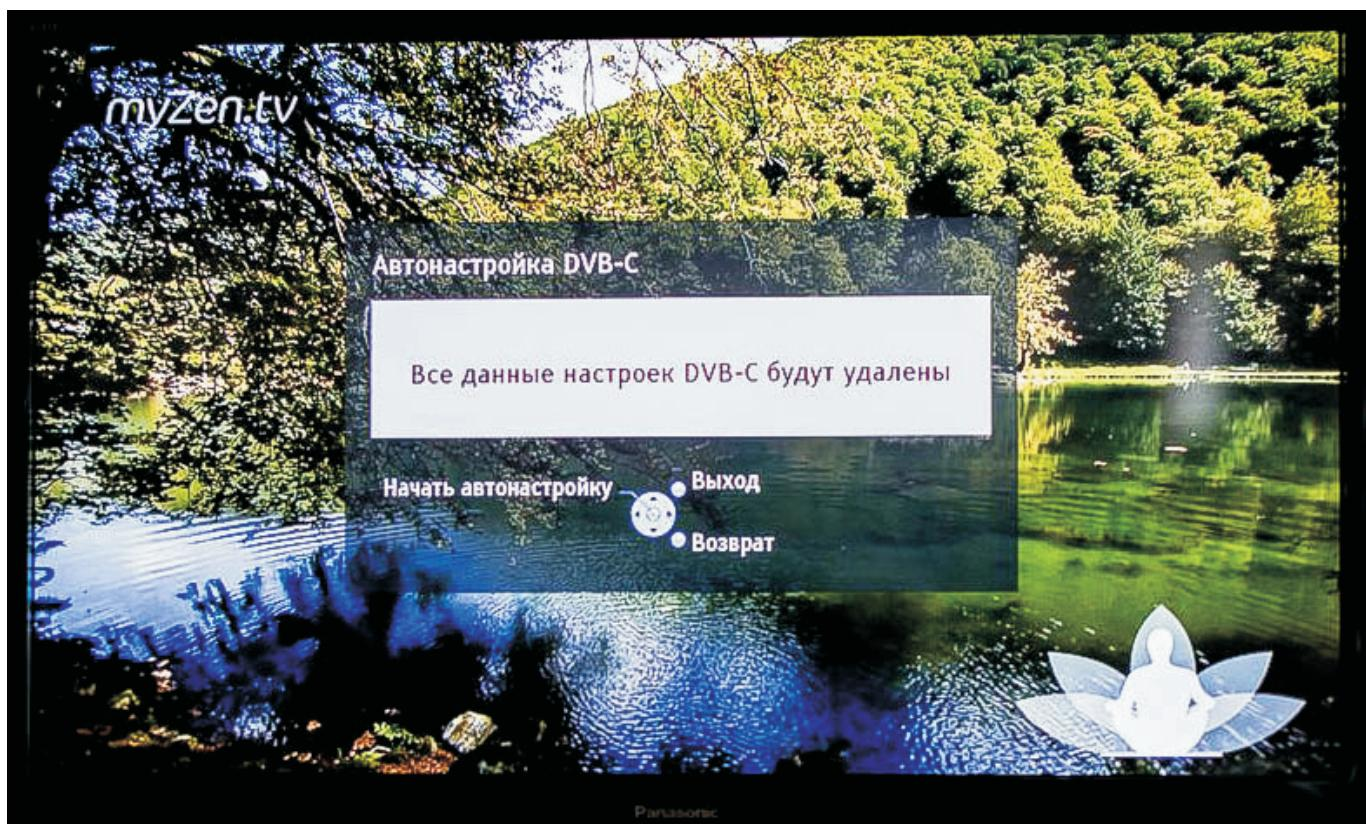
Поиск каналов может занять некоторое время. По окончании поиска каналов в режиме Автонастройки, телевизионный приемник сформирует таблицу найденных ТВ каналов и радиостанций.
