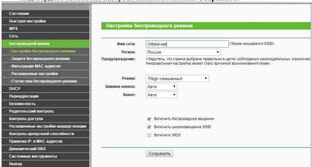
Для того, чтобы задать пароль на Вашу беспроводную сеть, перейдите в подраздел **Защита беспроводного режима**. Рекомендуется использовать тип шифрования **WPA/WPA2-Personal**. Пароль беспроводной сети может содержать от 8 до 63 символов латинского алфавита и цифры.
